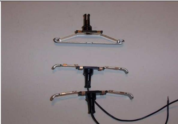
**Mittelschleifer mit Kunststoff Halterung für „Wagen Modell Asymmetrisch.“**
