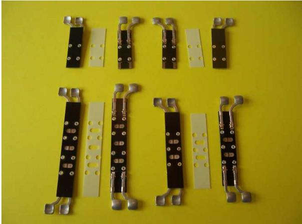
**Doppel Schleiferplatte mit Isolierplatte
