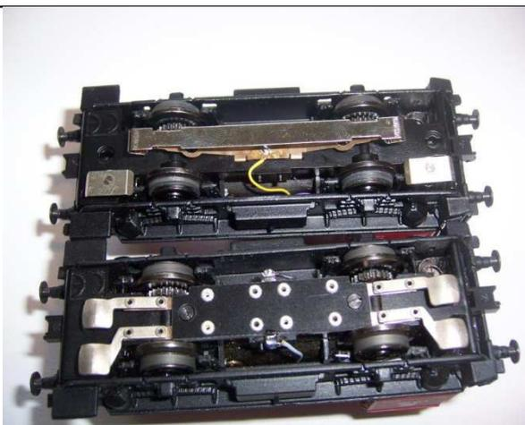
**Umbau Schleifer Einheit für V45 Modell
