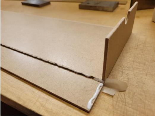
8. Die Seitenwand wieder komplett hochklappen, dann noch einmal kurz vorsichtig anlüften (ca. 30 Grad aufkippen), damit sich der Kleber gut verteilt, und abschließend wieder zusammenklappen. Zum Schluss die Seitenwand mit rechtwinkligen Stahlklötzen in der senkrechten End-Position fixieren.
