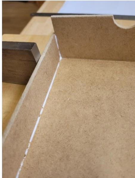
9. Den herausquellenden Leim mit dem Finger zu einer kleinen Kehle formen, und alles trocknen lassen, bis der Kaltleim voll transparent durchgetrocknet ist (etwas Geduld bitte 😊), dann das Tesakrepp-Band vorsichtig abziehen.
