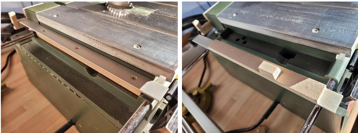
Ein MDF-Formteil, welches genau in die Öffnung des Sägeleistes eingepasst ist, verhindert ein unbeabsichtigtes Verlieren der Auflageleiste.
