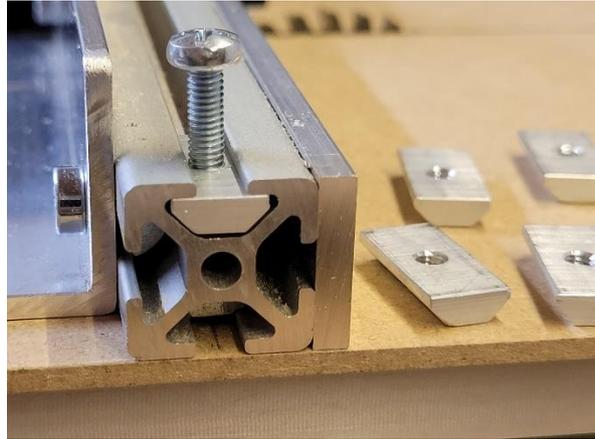
Zum neuen System gehören dann auch neue 6mm Bolzen mit einem partiell (7mm langen), auf 4mm abgesetzten Gewindedurchmesser. Dabei wird das 4mm Gewinde nur 5mm lang geschnitten. Die restlichen 2mm bleiben mit  $D=4\text{mm}$  gewindefrei.
