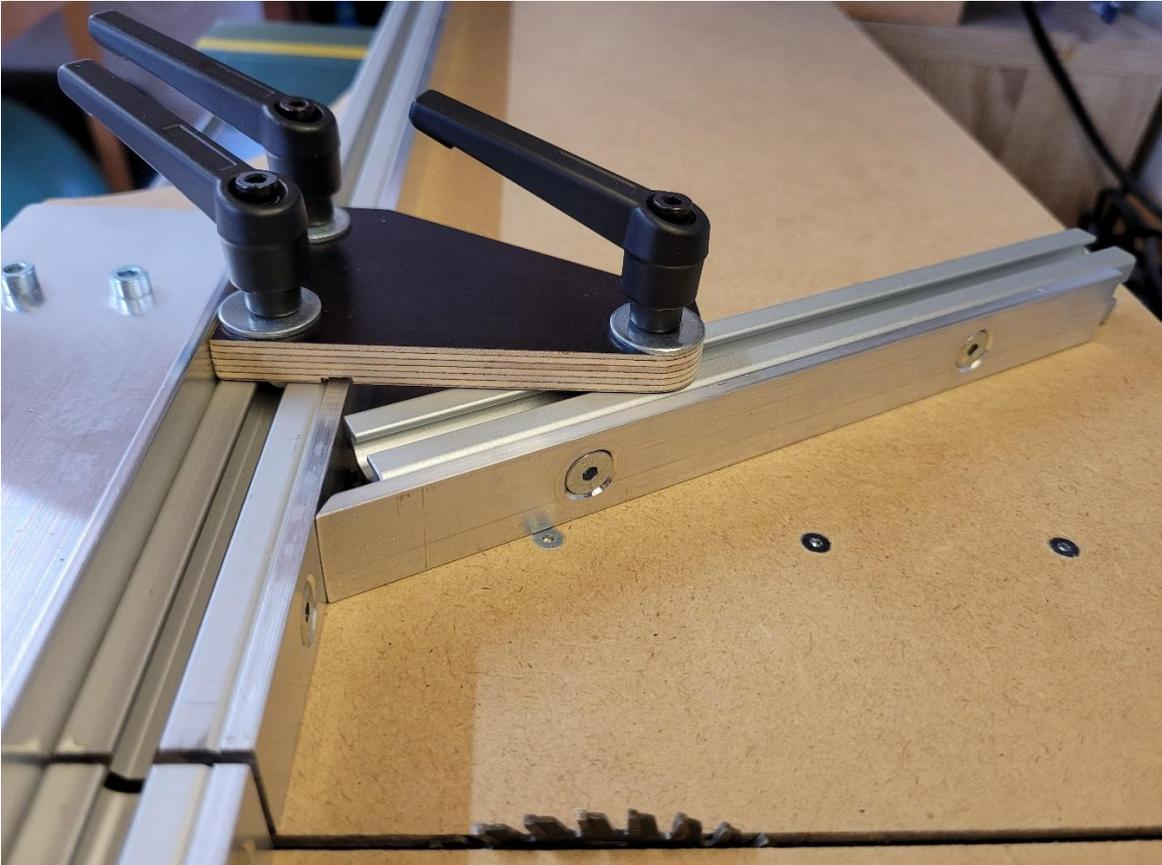
Bei der Gelegenheit gabs dann gleich noch einen neuen, schnell und einfach verstellbaren Längsanschlag. 😊
